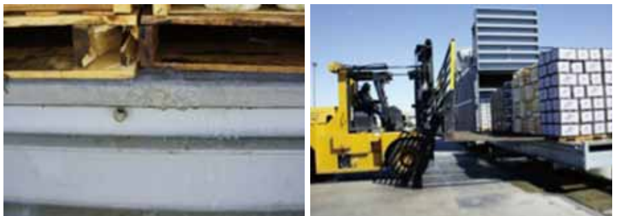
圖四、Hydro-vacuum cooling處理完之冰水附著棧板結冰情形,處理之後以大型堆高機將園產品送入冷藏庫中進行冷藏保存(拍攝於Ocean Mist company)。
