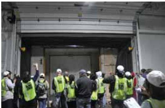
圖六 模擬農產品裝入列車之情形，接合處有伸縮布可減少冷氣散失與產品回溫。
