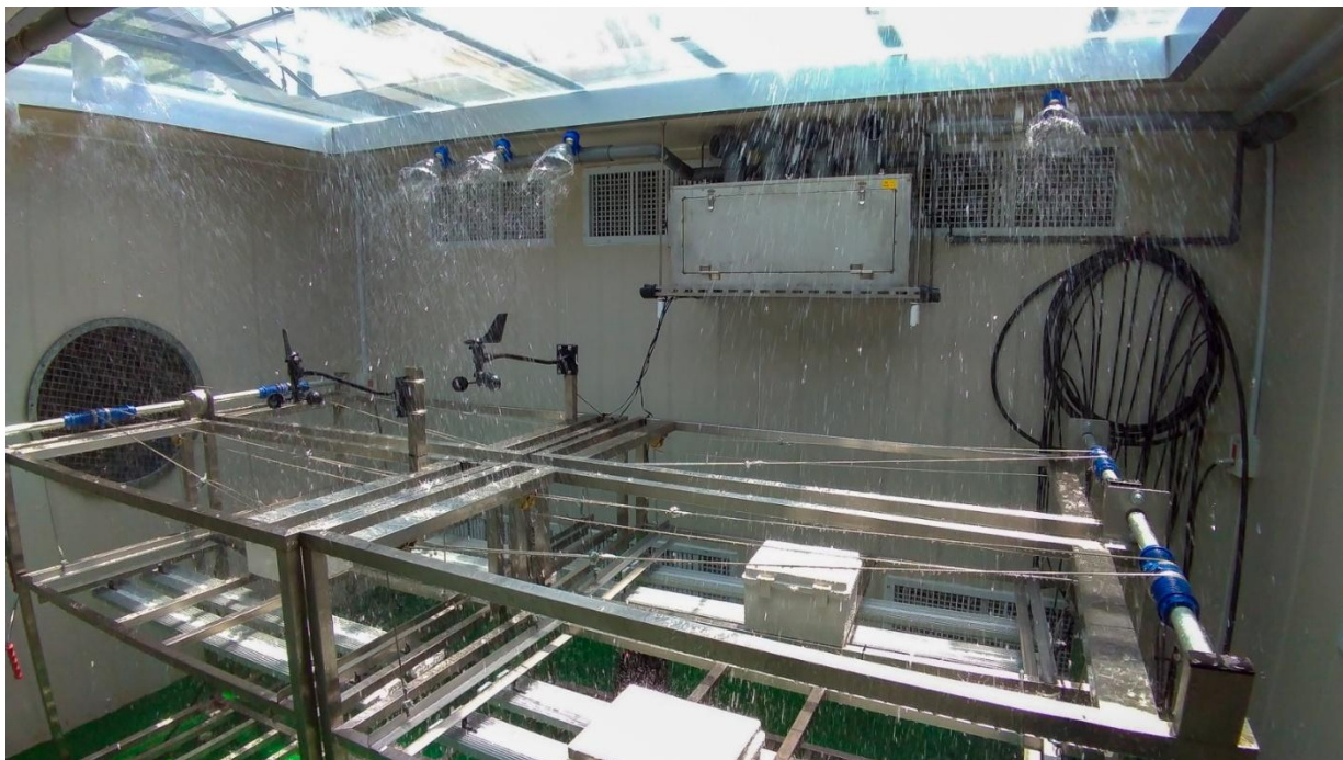
多重環境逆境模擬器可設定溫度、濕度、雨量、風速、光照與時間等 6 項因子。
