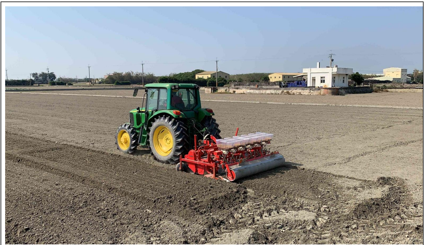
圖二、水稻乾式直播栽培在田區乾整地後，即以乾式直播機具進行播種，不需濕整地與灌水
