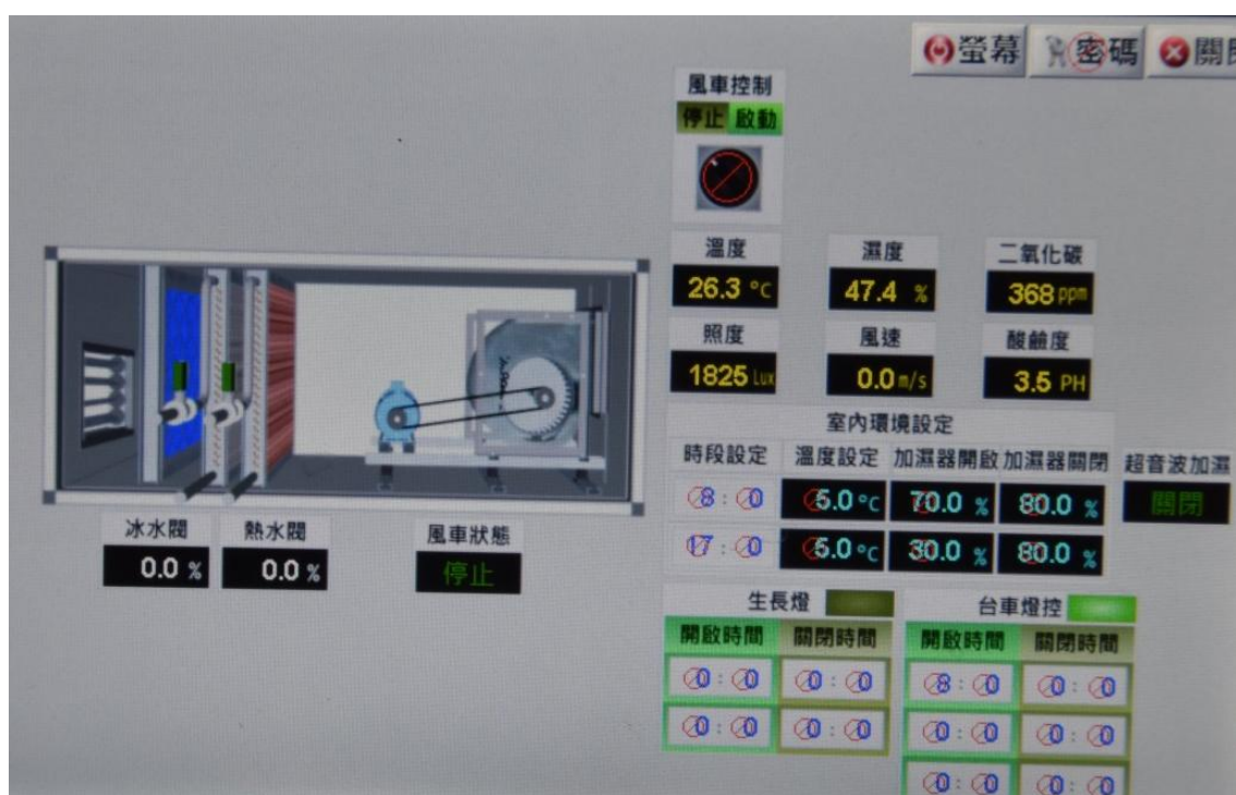
圖 3.低溫逆境篩選設施平台環控系統。
