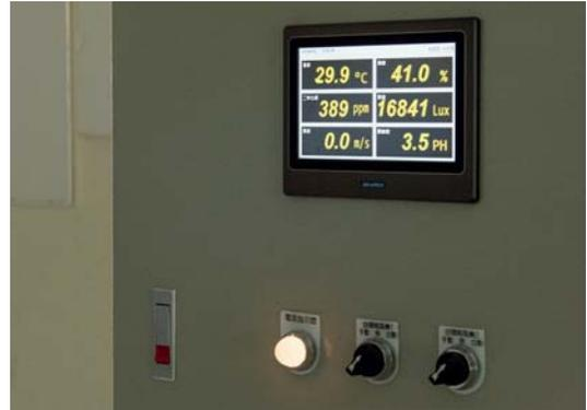
作物溫度逆境模擬試驗平臺監控畫面，此平臺具有溫度、濕度、光度感測器，依試驗需求可額外追加二氧化碳、酸鹼值、風速感測器。(攝影／謝佩穎)
