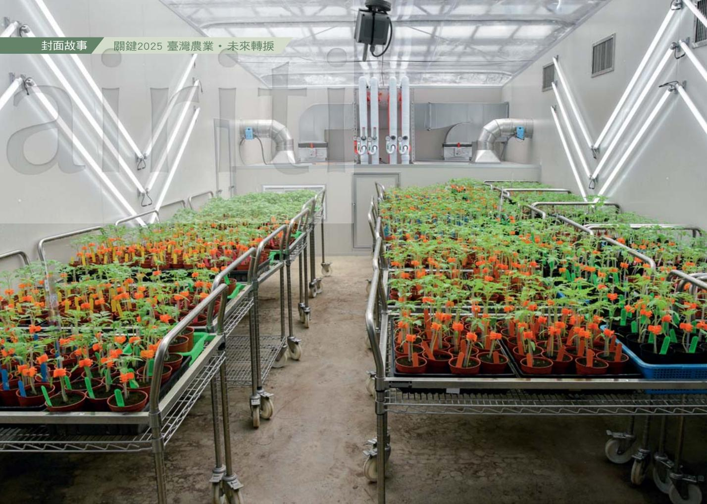
作物溫度逆境模擬試驗平臺進行番茄初級核心種原試驗，此計畫試驗種原計有 4,992 個品系。
