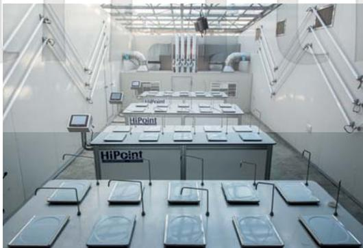
預備進行作物表型耐旱試驗，設有自動澆水秤重，每臺車可放置 10 個樣品，進行耐旱、耐淹試驗。
