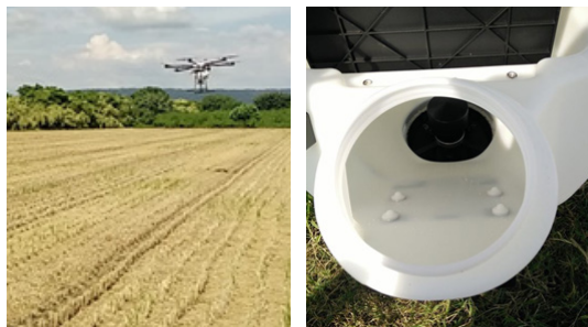
旋轉式撒播機測試 - 全部撒完，不卡料。
