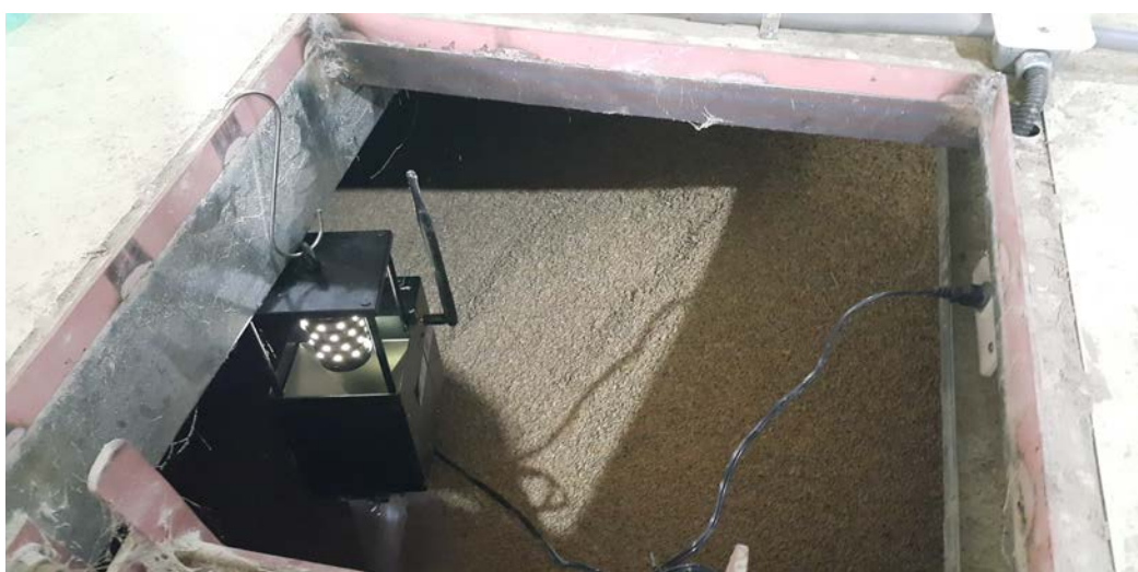
圖 2.糧倉害蟲監測管理系統-實倉架設狀況
