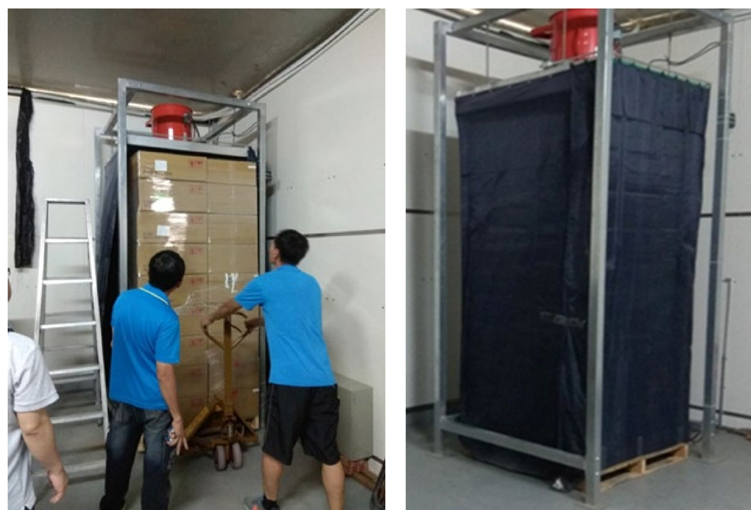
圖2. 蝴蝶蘭可以一次處理一個棧板，操作時，將棧板推入(左)。蝴蝶蘭壓差預冷狀態(右)。
