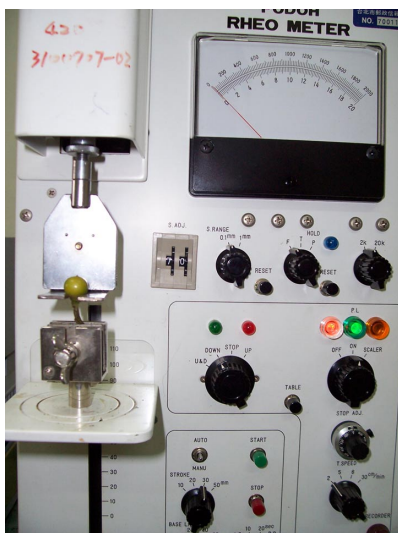
圖 1. 破布子果梗拉斷力測定實況 (左) 與受測材料 (右)。
