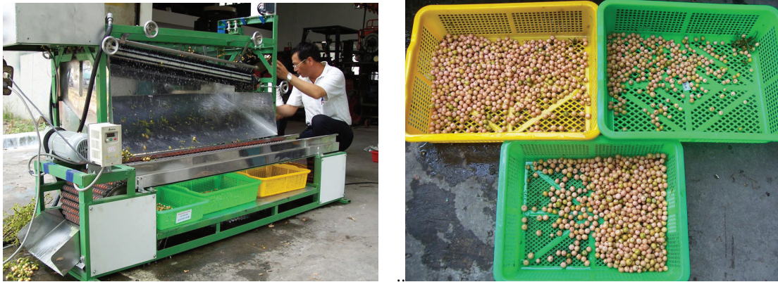
圖 11. 破布子脫粒篩選機作業狀況中（左）與篩選後之果粒（右）。
