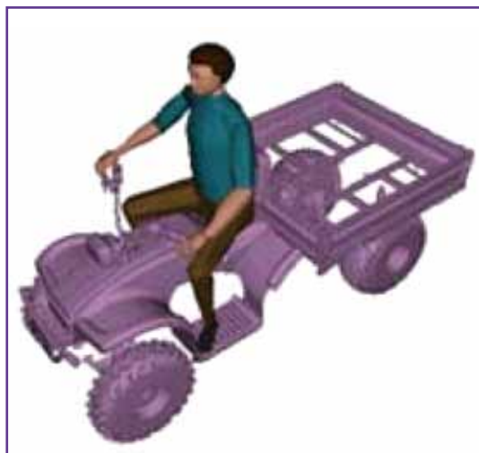
圖二、虛擬人駕駛農用搬運車之模型，藉此模擬搬運車之舒適度及操作性，使設計更貼近人性化。
