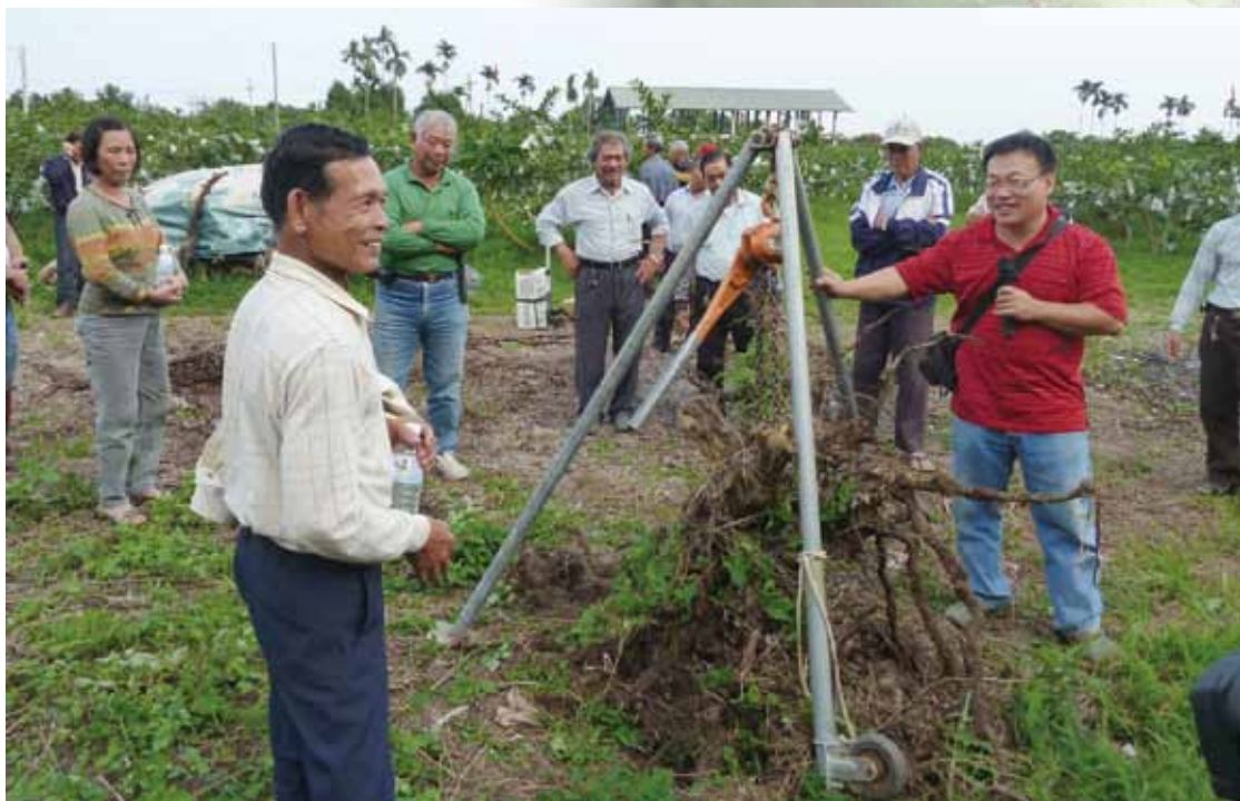
圖四、輕便型吊架重量較輕，一人即可操作。
