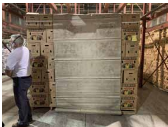
圖五、青椒隧道式壓差預冷。
