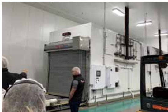
圖六、Modular Automated Cooling System 為一種新型自動化的壓差式預冷設備。
