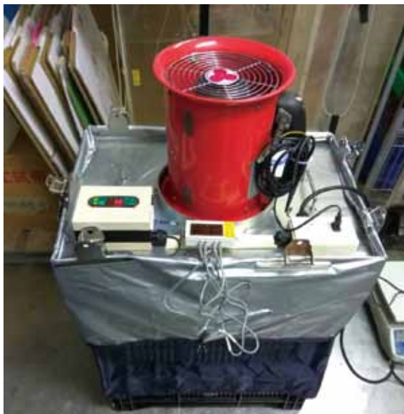
圖五、「頂吸式壓差預冷設施」實機。
