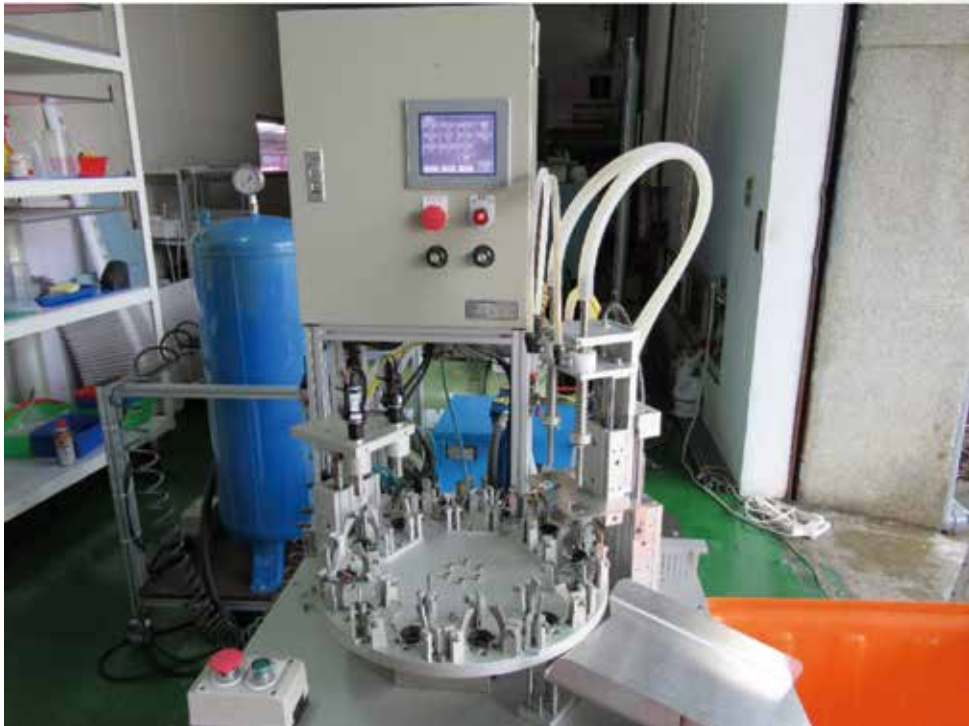
圖三、百香果取漿機械之果料轉盤機構與其所對應的各部作業作用位置圖。
