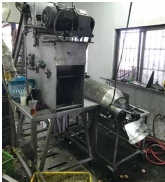
圖一、傳統的壓榨式取漿機械，因會造成果皮與果漿的污染而大多廢棄不用。
