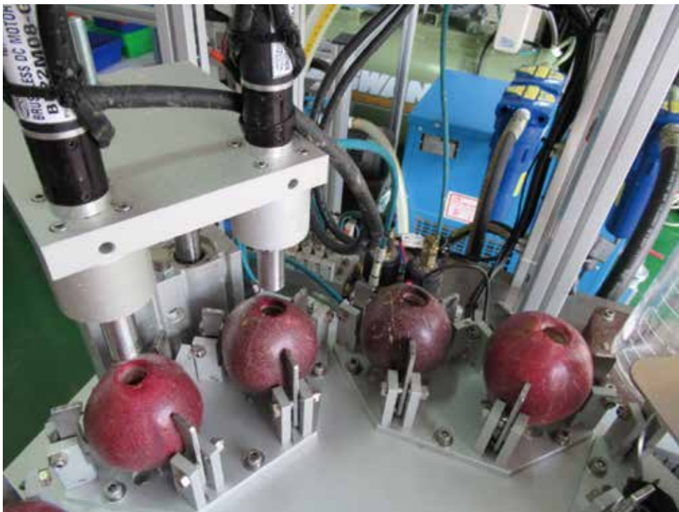
圖四、利用開孔鑽頭之開孔洗刀進行果殼的開孔作業情形。
