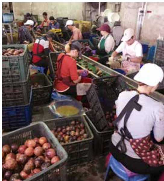
圖二、應用手工取漿方式，需耗費大量人力且加工場環境不符合食品安全衛生規範，無法達到食品等級的衛生品質規範要求。
