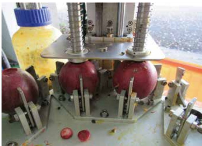
圖五、百香果果漿抽吸機構以正負高壓氣旋交互作用進行果漿抽吸之情形。
