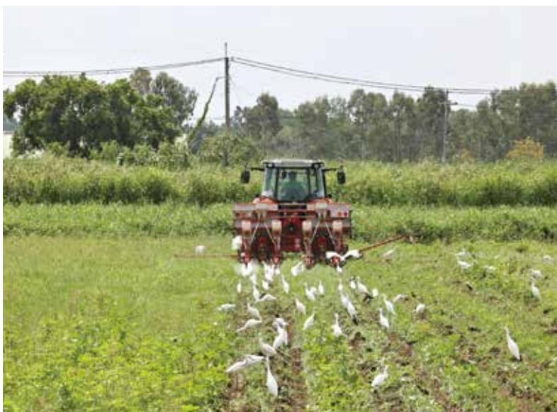
圖一、玉米不整地栽培作業機，除真空點播種外，兼具施肥和殺蟲劑條施作業。同時可利用雜草或上季剩餘的生物質進行敷蓋，降低土壤水分蒸發，夠多的生物質除可避免雜草的蔓生，建構適合種子發芽的土壤環境。
