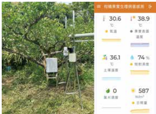
圖一、藉由紅外線熱影像感測模組搭配微氣象物聯網感測模組建立柑橘果實日燒預警系統。
