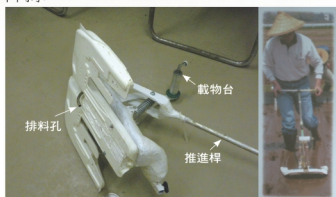
圖三、水稻試驗用直播機（左圖為直播機具，右圖機具操作示範圖）。
