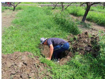
圖二、首先選擇最具代表性的地點，用鐵鏟開挖土坑，約1米深、1米寬
