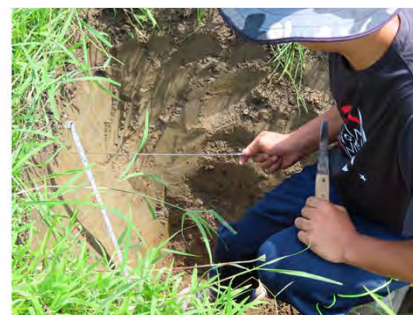
圖四、使用穿刺棒檢查土壤硬度。
