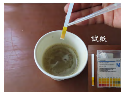
圖七、土壤酸鹼度檢驗，以1份土及2份水比率置入紙杯並充分攪拌，靜置至少5分鐘待土壤沉澱，用吸管取上澄清液，滴在試紙上。
