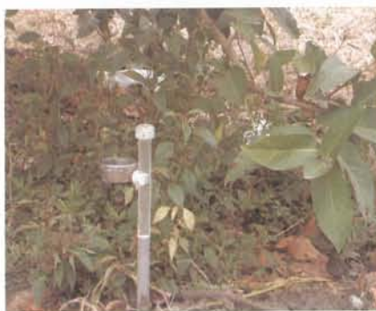
圖四、蓮霧園埋設土壤水分張力 計以利水分管理
