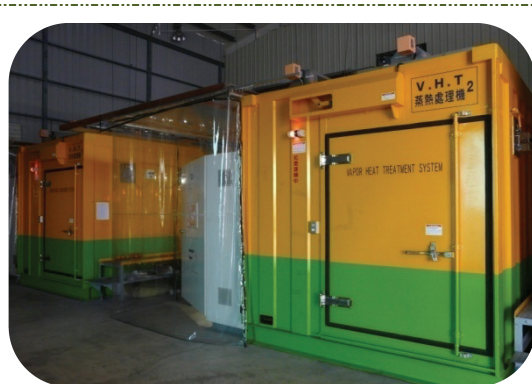
圖 4. 臺南楠西處理場蒸熱庫。
