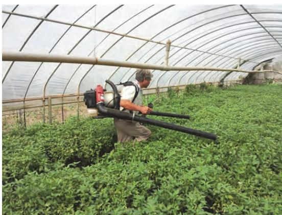
圖 7. 第一代害蟲擾動及吸捕防治機械 田間吸捕測試情形
