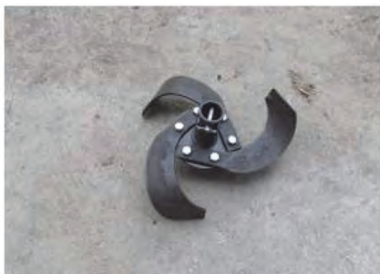
圖7 破土機構使用之迴轉犁
