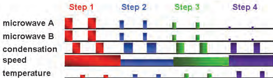
圖4 四階段式時序控制示意圖
