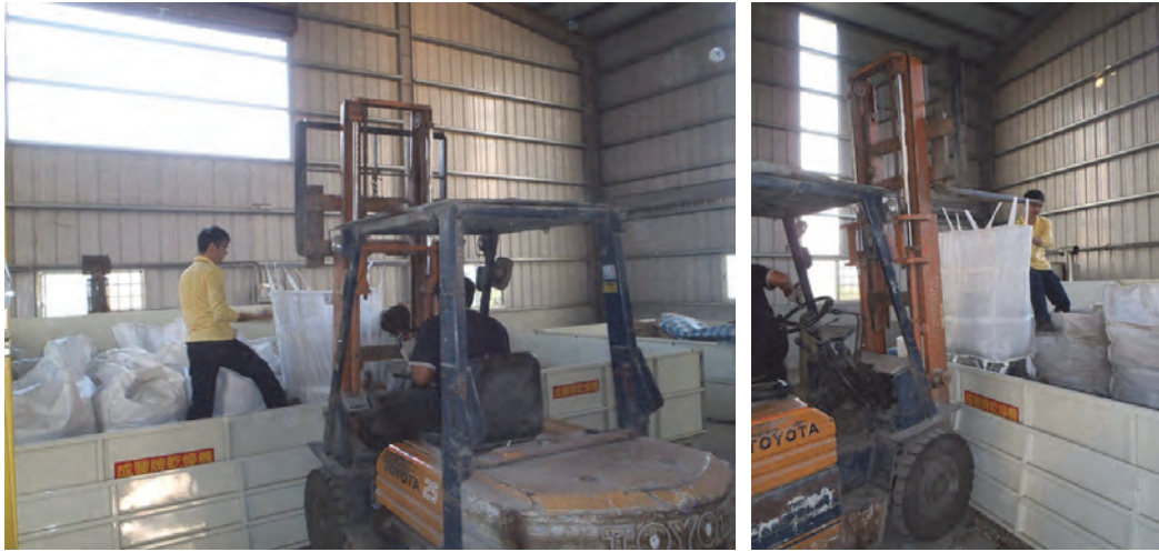
圖9 利用堆高機進行乾燥太空包的出倉作業情形
