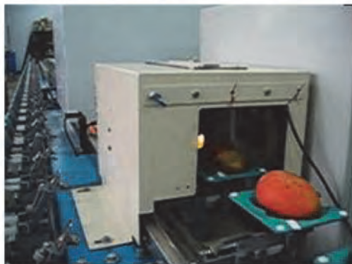
圖5 近紅外線水果內部品質檢測系統(蓮霧及芒果)
