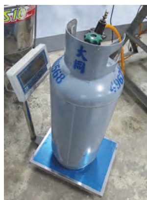
圖6 量測瓦斯桶重量
