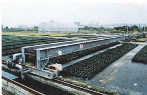
利用空中輸送機架設於田間軌道，可供搬運及噴水的工作(花之鄉)
