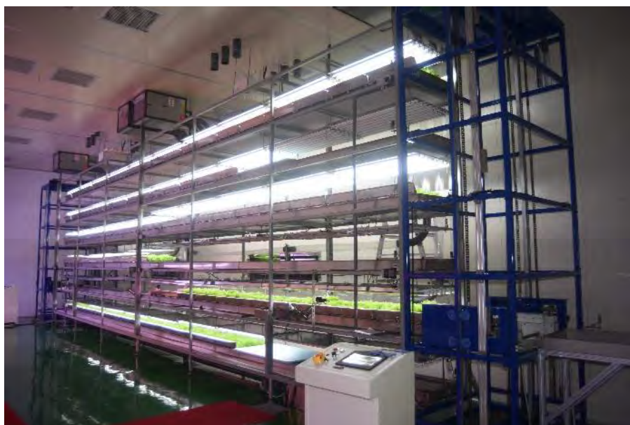
圖 1. 立體化多層次栽培作業系統進行萬苳之栽培情形
