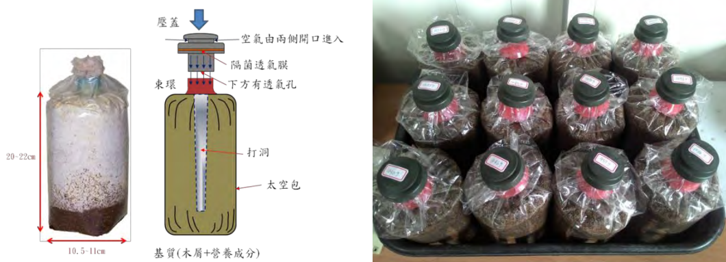
圖四、傳統束環(棉花束套式)太空包及與新式束套(束環+壓蓋)太空包之比較
