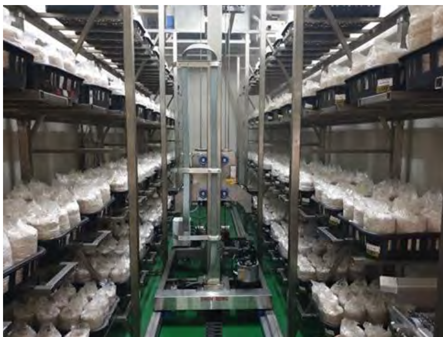
圖 4. 菇類智慧化自動栽培作業系統
