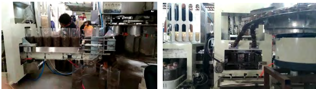
圖八、CN201510337244.3 菌袋自動套套環機(興寶機械)
