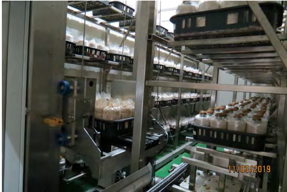
圖 5. 太空包栽培盛盤出/入庫轉位定植基座
