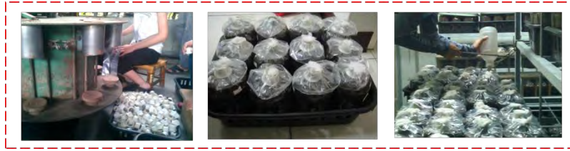
圖三、傳統袋式太空包製包菌種壓包製程[2]；需大量人力之製包與接菌作業
