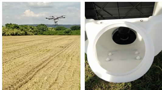
旋轉式撒播機測試 - 全部撒完，不卡料。
