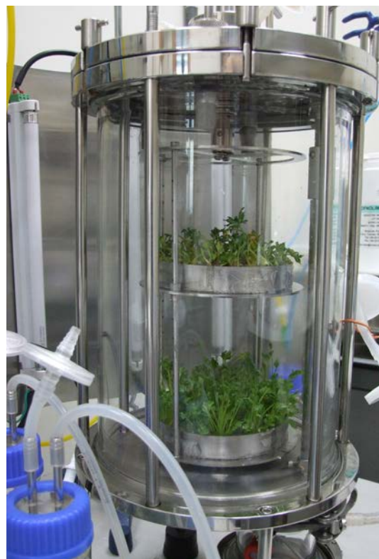
氣霧式植物栽培器（農業試驗所研發並由欣梗科技股份有限公司合作製造）。
