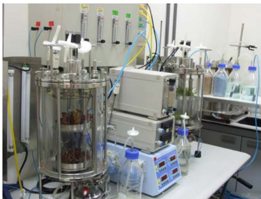
氣霧式生物反應器培養系統（農業試驗所研發並由欣梗科技股份有限公司合作製造）。
