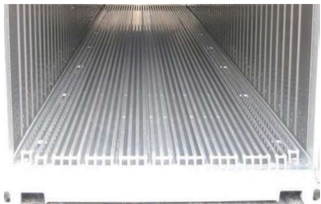
圖10 冷凍櫃內部T型地板。
