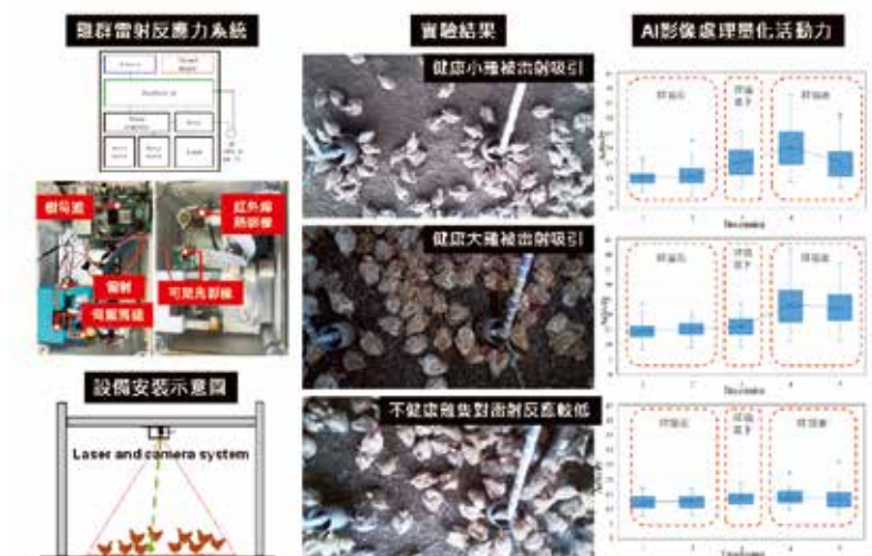
圖 5. 雞群雷射反應力影像評估系統與成果圖
