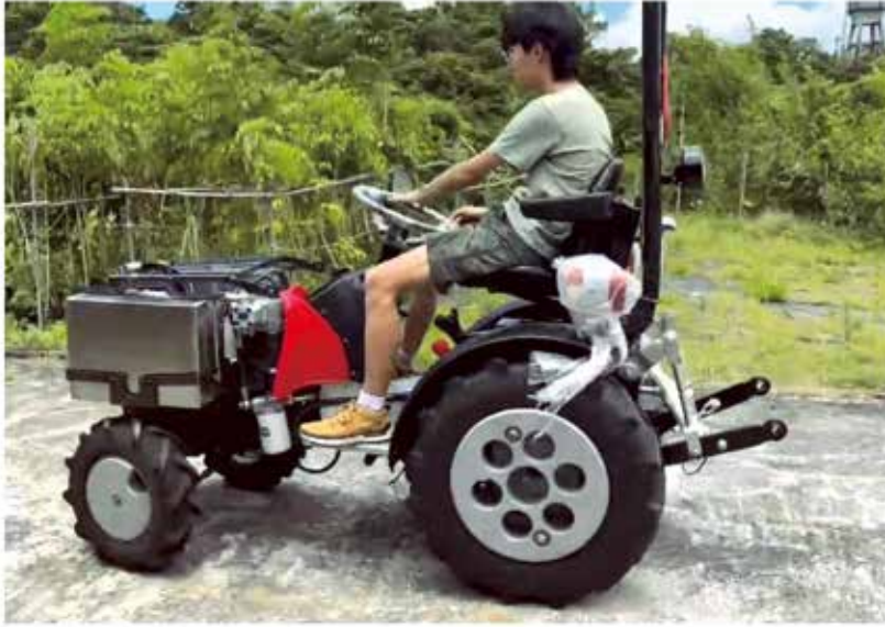
圖 3. 電動曳引機 (12kW，2,400~6,500rpm 96V 水冷直流無刷馬達)
