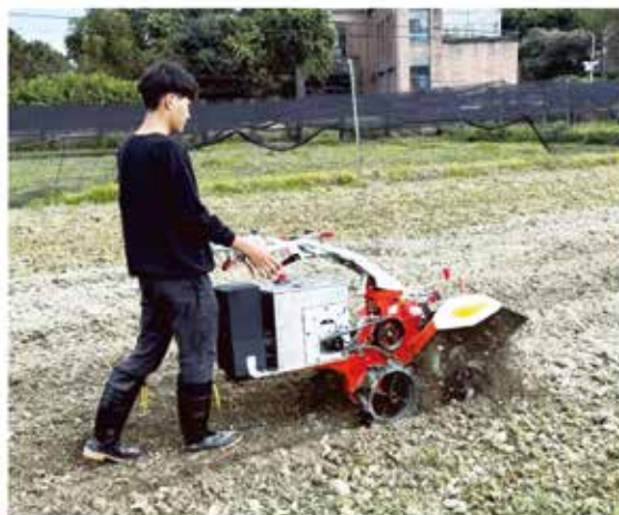
圖 1. 電動中耕機 (3.5kW，1,800rpm 48V BLDC 馬達)
