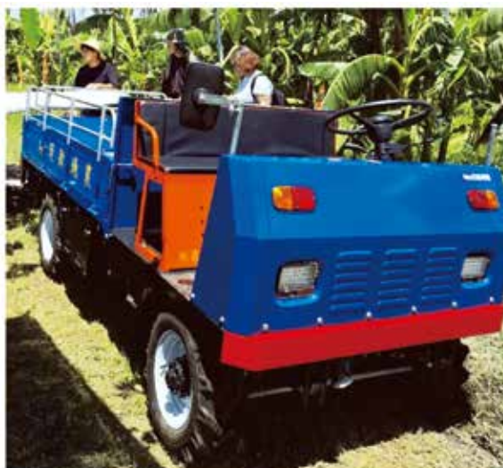
圖 2. 電動搬運車 (6kW，3,600rpm 72V 氣冷直流無刷馬達)
