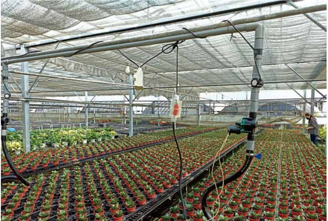
圖 6. 以土壤濕度計偵測介質含水量，灌溉控制器自動給水
