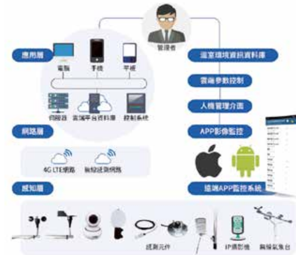
圖 6. 智慧環控系統整合與雲端資料庫資料收集
