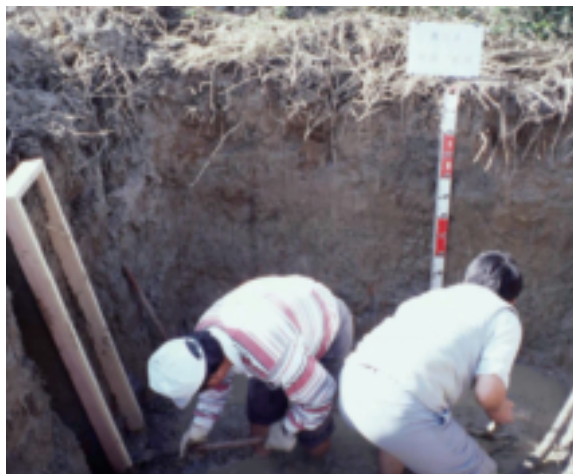
1970年代進行的土壤調查作業，同仁正採取土壤剖面標本。
