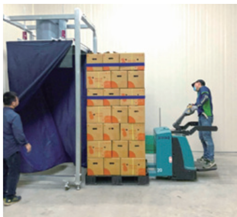
以堆高機將園產品送入頂吸式壓差預冷模組內。
