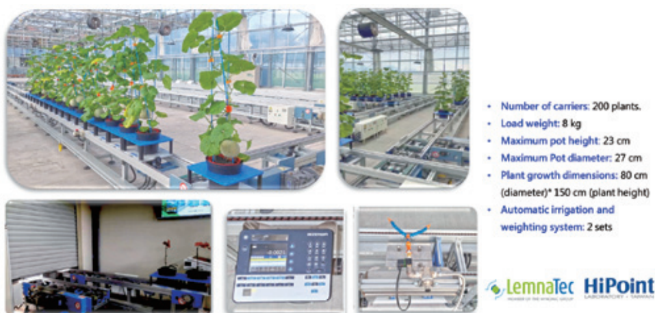
德國 LemnaTec PhenoAlxpert HT 輸送帶系統。
