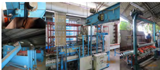
圖 2-5 菇類介質填充自動化作業模組。
