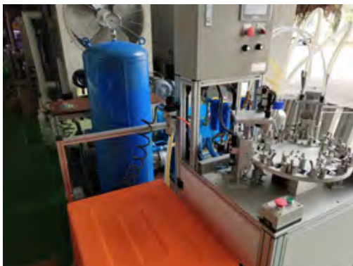
圖 8-1 百香果果漿抽取機之外觀結構。
