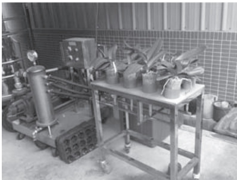
圖 1. 利用真空抽氣機抽離蝴蝶蘭栽培盆內水草介質之水分。
