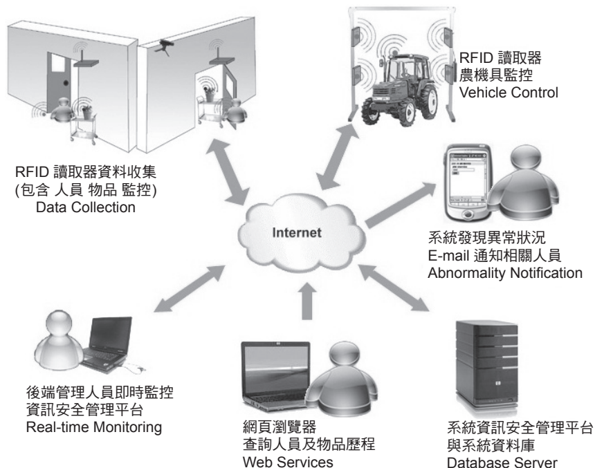
圖 2. 本研究基因轉殖作物生物安全管理系統架構示意圖。
