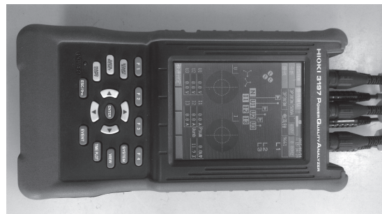
圖 4. HIOKI-3197 電力品質分析儀。 Fig. 4. HIOKI-3197 power quality analyzer.
