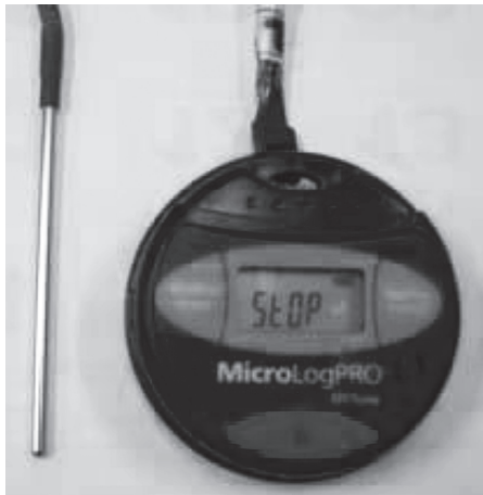
圖 2. MicroLog PRO-EC750 及溫度探針。 Fig. 2. MicroLog PRO-EC750 hygrometer and probe.
