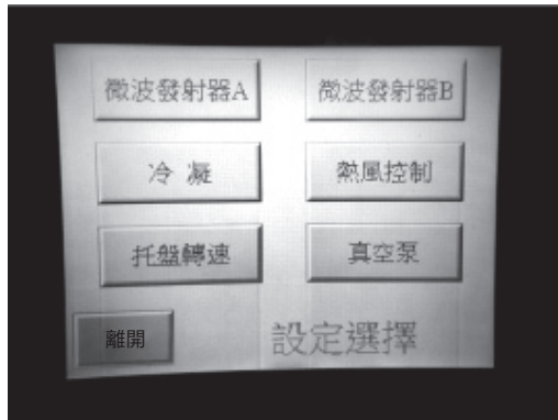
圖 2. 微波冷凝乾燥系統人機介面。
